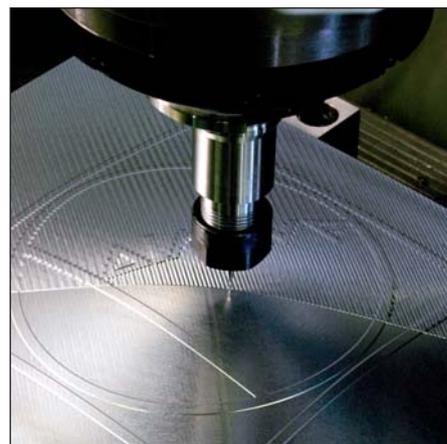
Con il termine **Dynamic Precision** si combinano funzioni opzionali per i controlli numerici HEIDENHAIN, che riducono significativamente gli errori dinamici delle macchine utensili. Migliorano il comportamento dinamico della macchina, conseguono una maggiore rigidità nel TCP e consentono così di fresare al limite delle possibilità tecnologiche indipendentemente dall'età della macchina, dalla sua sollecitazione e dalla posizione di lavorazione.
