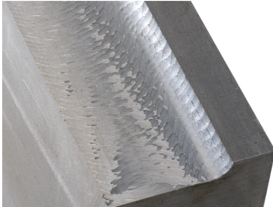
Asportazione elevata del truciolo senza ACC
