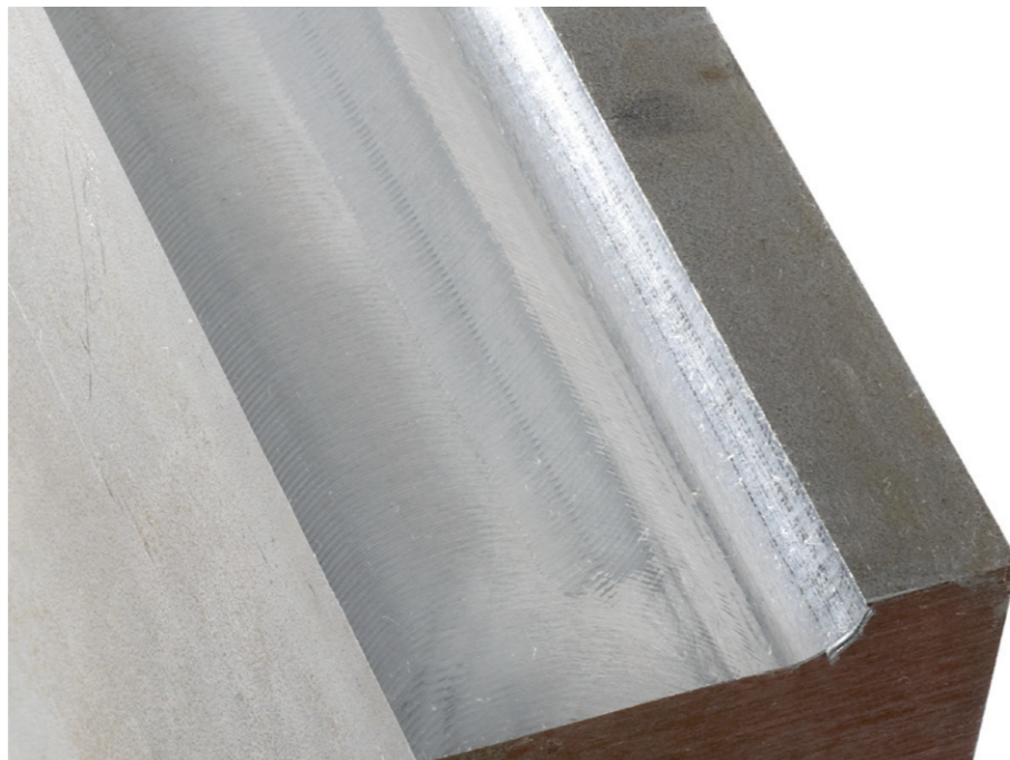
Asportazione elevata del truciolo con ACC
