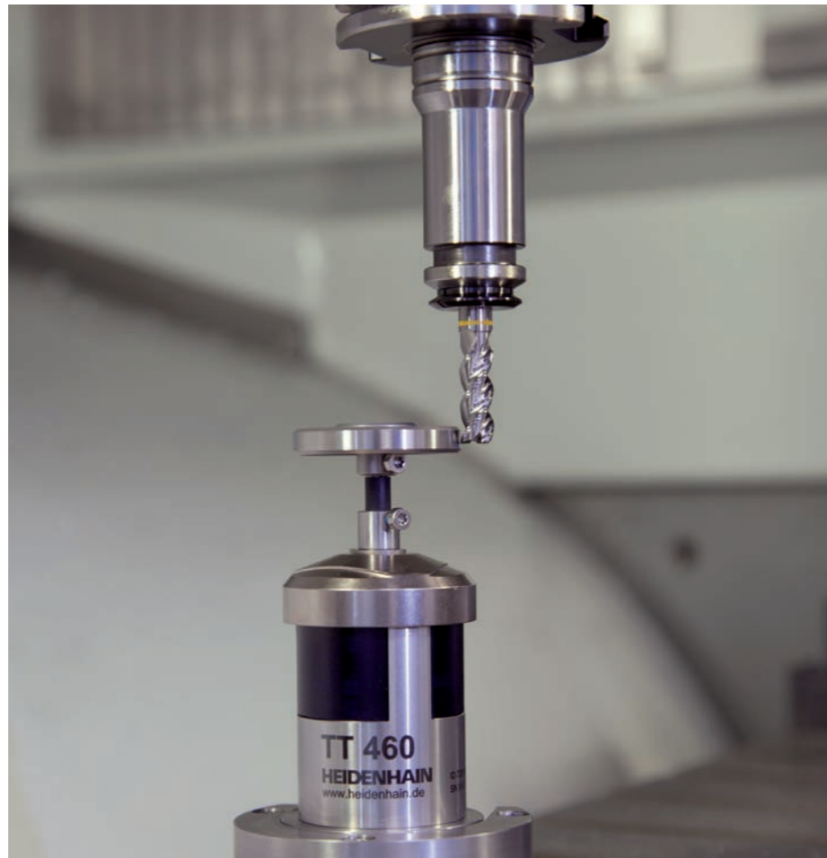
Misurazione di singoli taglienti, ad esempio per la verifica di placchette riportate (non per taglienti sensibili alla rottura)
