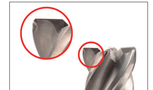
Bearbeitung ohne OCM: Werkzeug nach 2 Teilen
