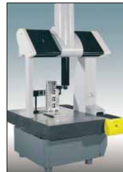
Global Activ: 16 sonde termiche per controllare la struttura meccanica e il pezzo da collaudare
