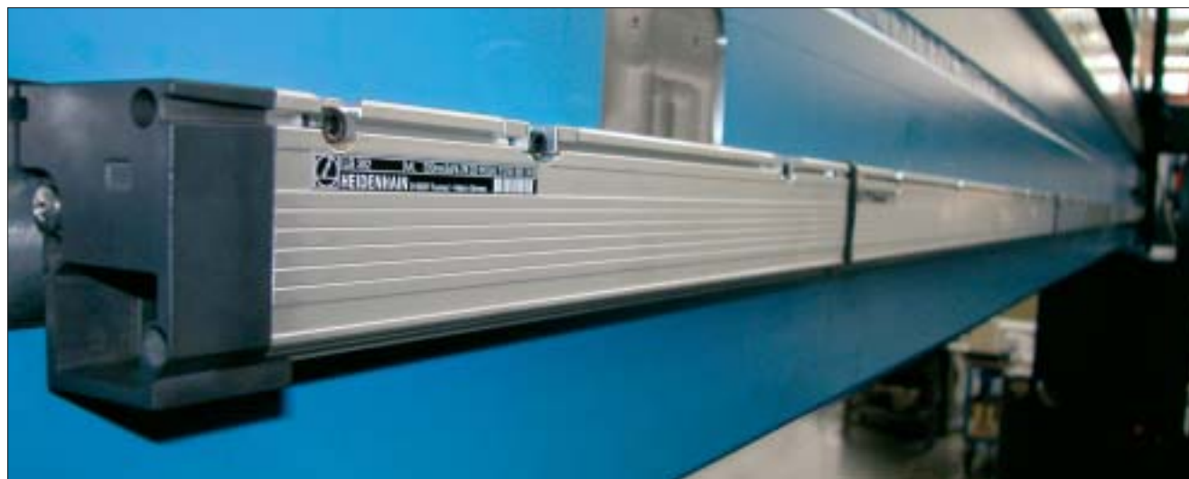
Gli assi di movimento di Optimo sono estremamente precisi anche grazie alle righe ottiche HEIDENHAIN
