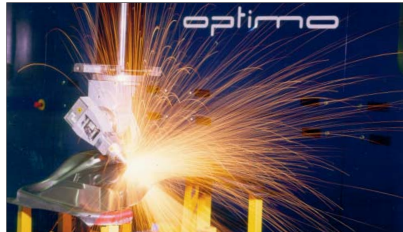
La testa di taglio di Optimo durante la lavorazione di un componente automobilistico
