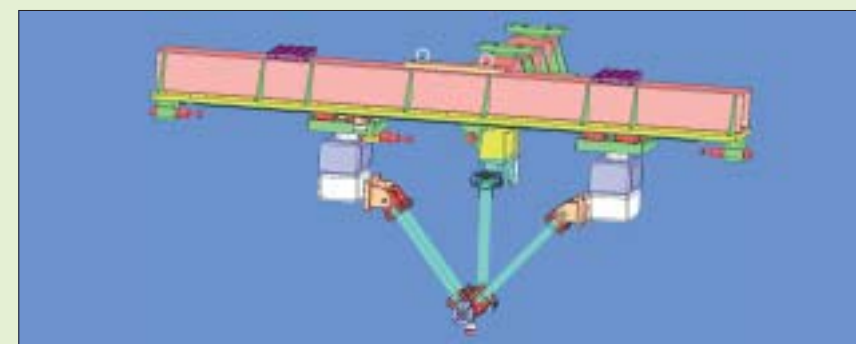
Macchina con 6 gradi di libertà funzionante nello spazio
