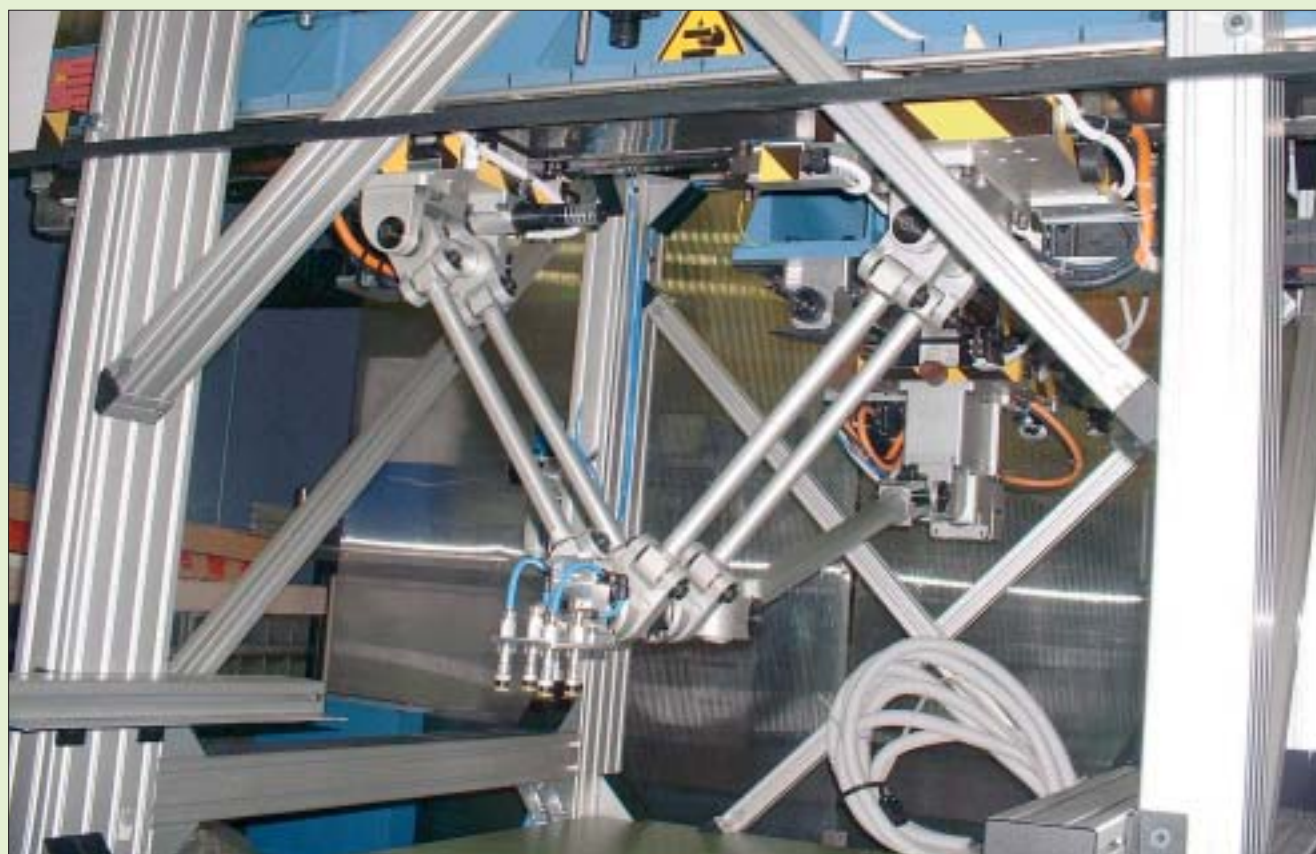
MorpheuM è una macchina a cinematica parallela sviluppata dall'ITIA - CNR, in collaborazione con HEIDENHAIN
