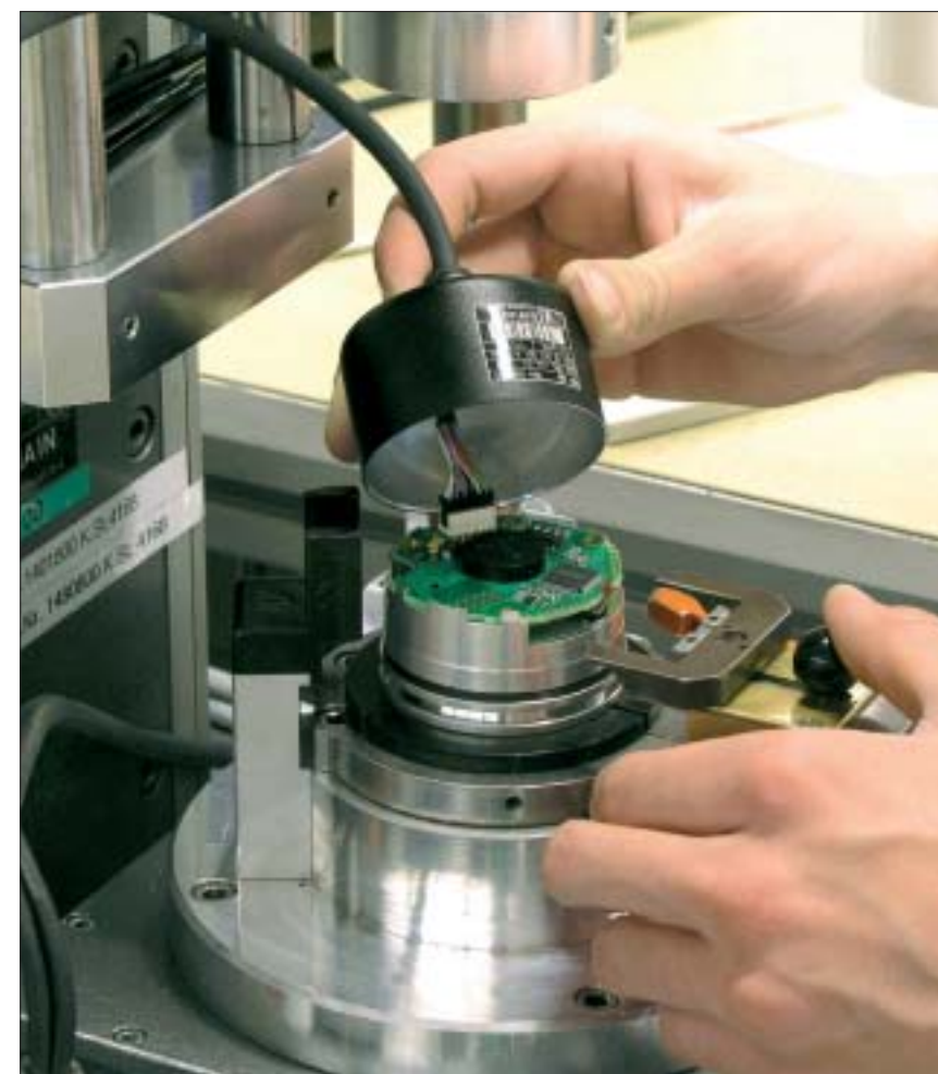
Dopo la taratura si procede all'applicazione a compressione del gruppo cappello
