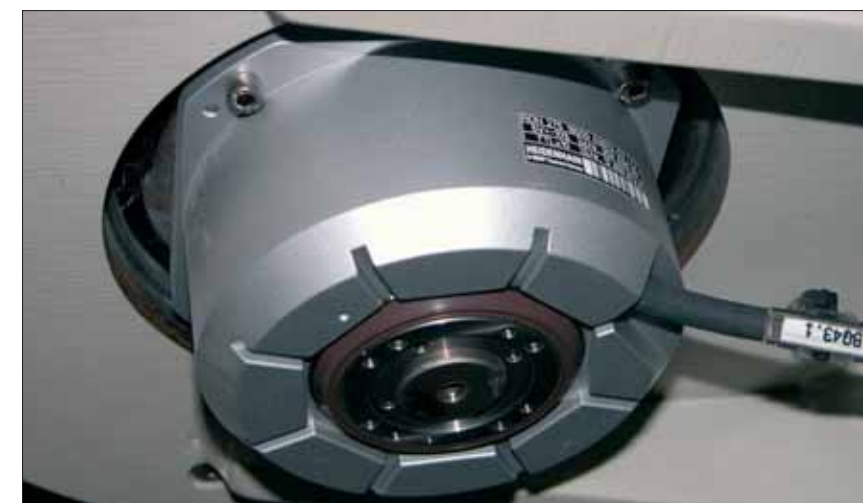
Motori direct drive abbinati con feed back posizione-velocità HEIDENHAIN
