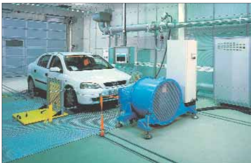
Banco prova di veicoli a recupero di energia
